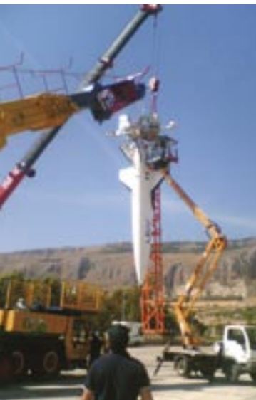
Base ASI di Trapani Milo (Sicilia). Sistemazione dell'USV in posizione verticale per l'aggancio al pallone stratosferico.
