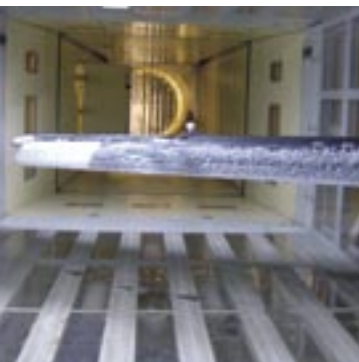
Modello di ala con formazione di ghiaccio all'interno della camera di prova dell'Icing Wind Tunnel del CIRA
